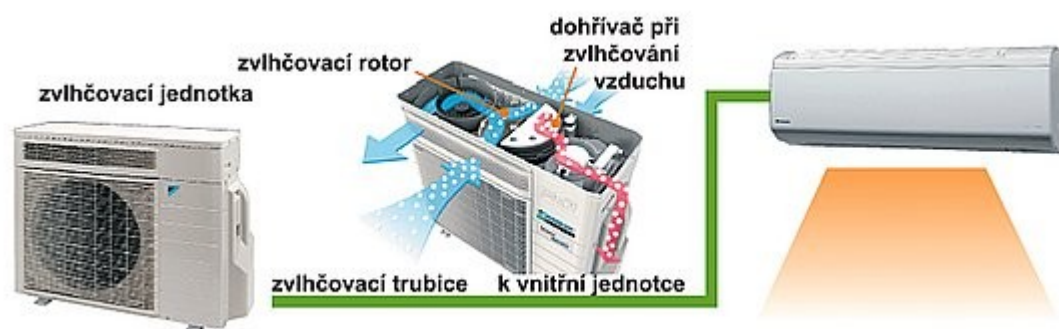
Obr. 2: Zvlhčovací rotor absorbuje vlhkost ze vzduchu, který si nasála venkovní jednotka. Vlhkost je dodávána do místnosti zvlhčovacími trubkami
